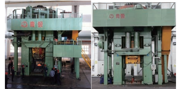
左图：EPC-8000 型 80MN 电动螺旋压力机
