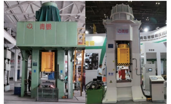
左图：EP-1600Z 型 16000kN 直驱式数控电动螺旋压力机
