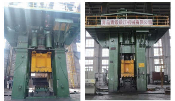
左图：FCP-16000 型 160MN 重型数控摩擦螺旋压力机
