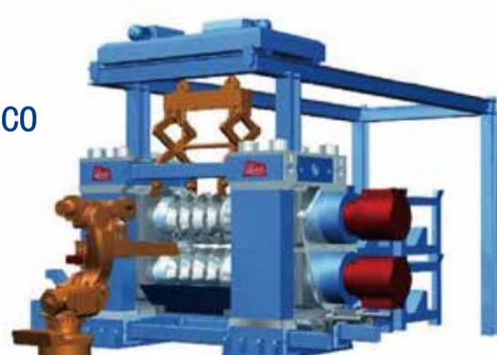
锻造生产需要精确地进行材料分配，以保证金属成形的外型尺寸。LASCO公司基于自己的机械原理，通过使用自动化辊轧预制坯设备而确保用户更有效地利用原材料，并确保成形产品的一致性。通过使用LASCO公司生产的QKW和RCW系列设备，LASCO公司可以提供楔横轧和辊锻预成形而建立柔性自动化生产线。楔横轧设备主要用于圆料制坯，方料可以使用辊锻制坯。在一些情况下，一台设备可以满足这两种工艺的需要。由于成形精度好，这些设备也可以用于做成形设备使用，例如用于生产台阶轴及轮毂。
