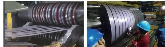
由于嘉兴加工中心分条设备首次加工此类订单,公司产销人员和客户外检人员高度重视,密切关注加工情况,生产一部林承锋部长更是全程坚守、跟踪指导,通过现场间隙参数调整,最终一次过刀成功。
