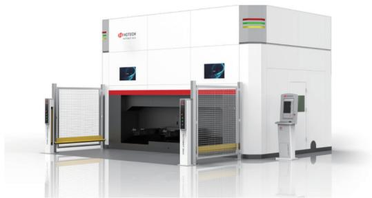
产品主要解决三维金属热成形件的开孔、修边问题，满足汽车、轨道交通等领域大型、复杂曲面零件新结构、轻量化、高柔性的制造需求。
