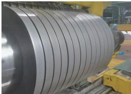
该批产品的钢种为 42CrMo4,是一种综合力学性能好、淬透性能好、应用广泛的中碳合金结构钢,在机械行业中常用于制造齿轮、连杆、高强度螺栓等重要零部件。
