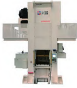
图3 兴锻机械伺服冷锻压力机
