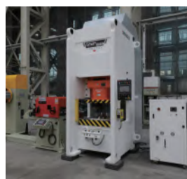
图7 扬力机械伺服单点压力机
