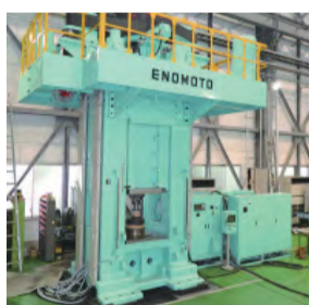
图2 樱本机械伺服螺旋压力机
