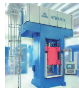
图4 合锻液压伺服冷锻压力机 图5 拉斯科机械伺服辊锻机 图6 拉斯科机械伺服楔横轧机
