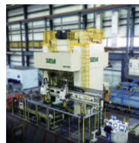
图13 法因图尔机械伺服精冲机 图14 兴锻伺服双点肘节式220T精冲压力机 图15 协易机械伺服热冲压压力机
