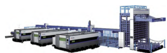
图3 大族激光智能装备集团激光切割柔性生产线
