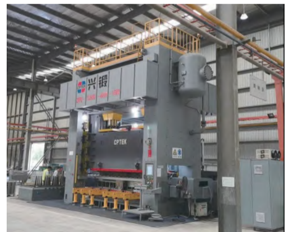
图4 兴锻1250吨双电机伺服驱动闭式多工位冲锻复合成形压力机
